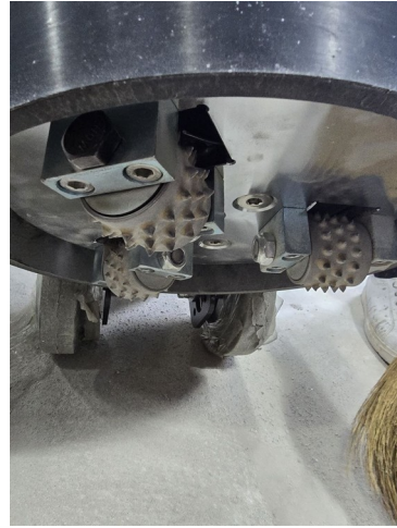
② 장비 하부 — 부시해머 커터 장착 상태
